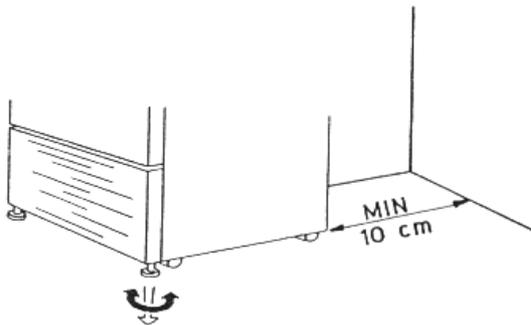
2) Für einen energiesparenden Einsatz ist eine ausreichende Luftzirkulation erforderlich. Daher sollte an der Rückseite ein Wandabstand von mindestens 10 cm eingehalten werden.
