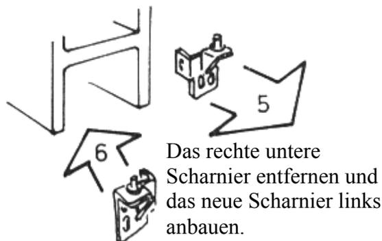
Das rechte untere Scharnier entfernen und das neue Scharnier links anbauen.
