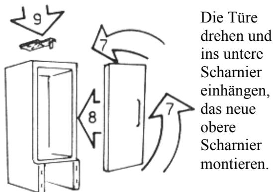
Die Türe drehen und ins untere Scharnier einhängen, das neue obere Scharnier montieren.
