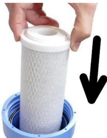
5. Den von innen und außen abgspülten neuen Filtereinsatz einsetzen. Korrekten Sitz der Dichtungen prüfen.
