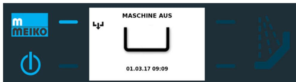
➔ Die Spülmaschine schaltet nach Beendigung des Vorgangs in den Modus **MASCHINE AUS**.
