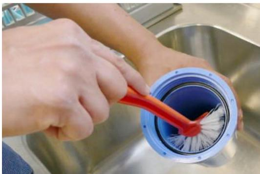
3. Filtergehäuse gründlich reinigen und ausspülen. Ablagerungen entfernen.
